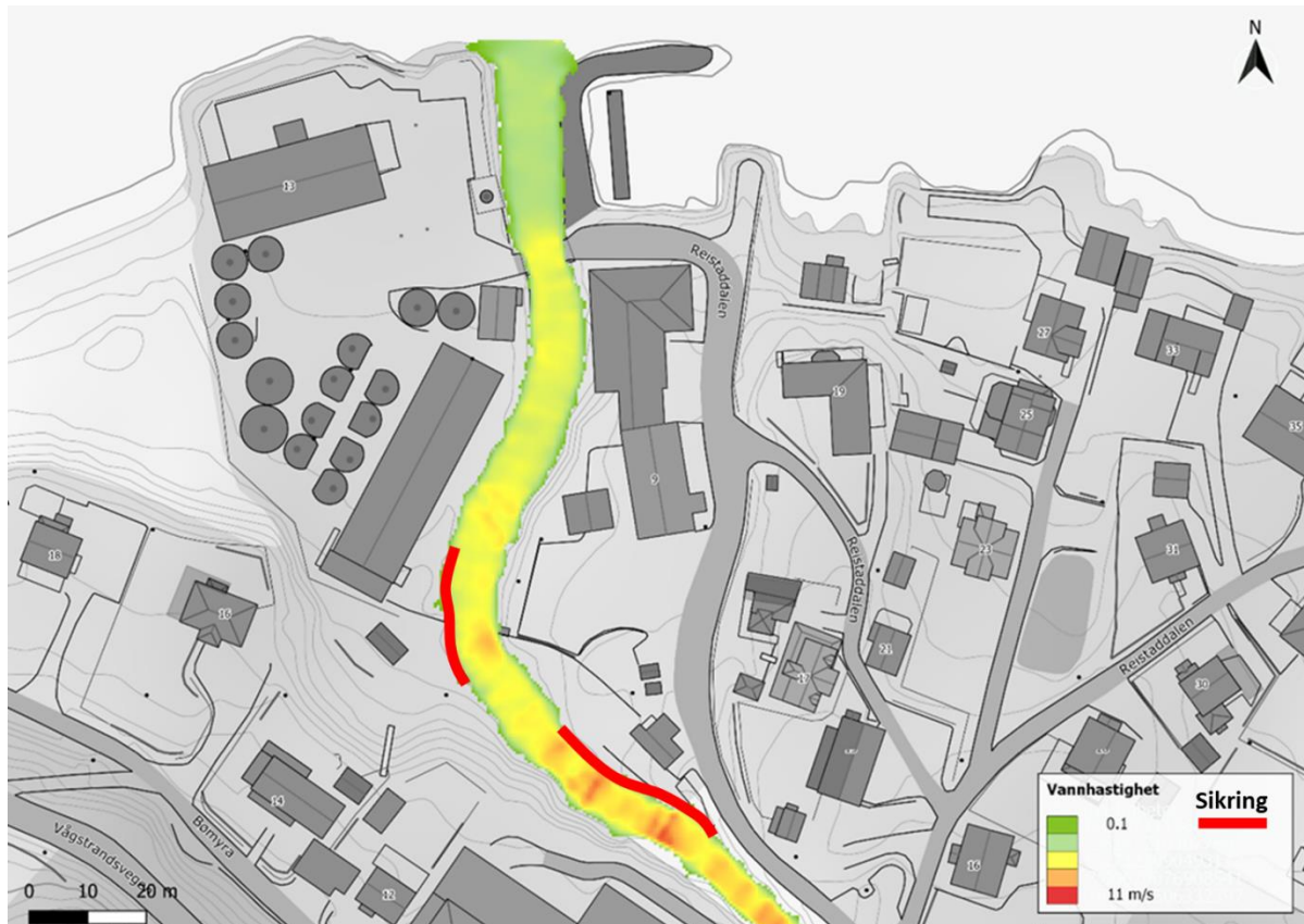
Vedlegg 6. Forslag til sikring av eiendommen mot flom- og erosjon markert med rødt
