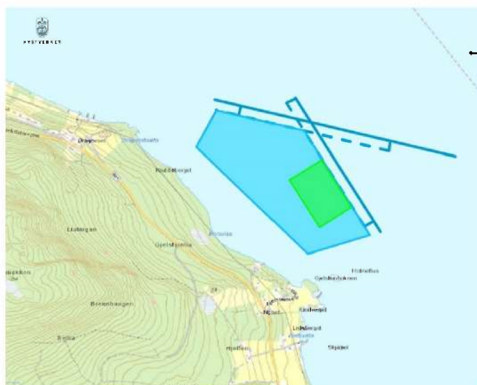
Bilde 3: Lokalitet Dragnes – Hauge Aqua Farming AS, oddetallsone (blå ramme). Grønn firkant viser rammefortøyning på 7 m dybde, hvor Egg/merder vil ligge innenfor. Mørk blå linjer er sektorlinje farled med tilhørende stiplet sikkerhetssone.
