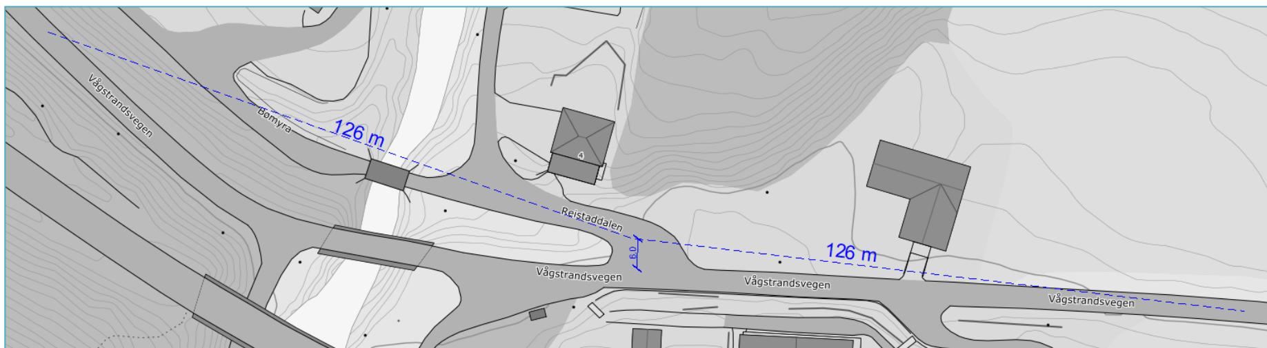
Figur. 21 Krav til frisikt for kryss for vegklasse vegklasse L1 med fartsgrense 60 km/t for primærveg.
