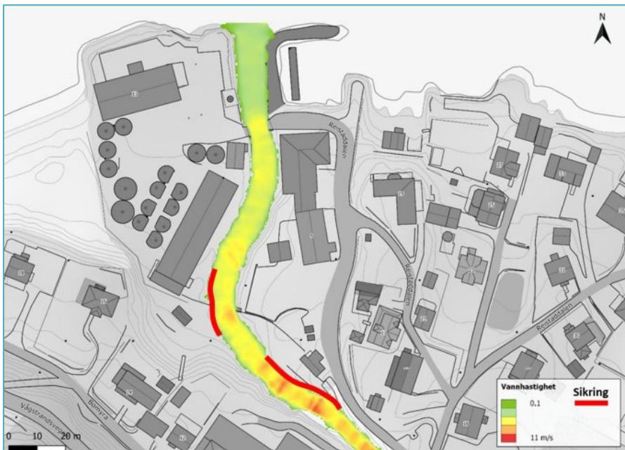
Figur. 25. Framlegg til sikring av planområdet mot flaum. og erosjon. Kjelde Hydrateam
