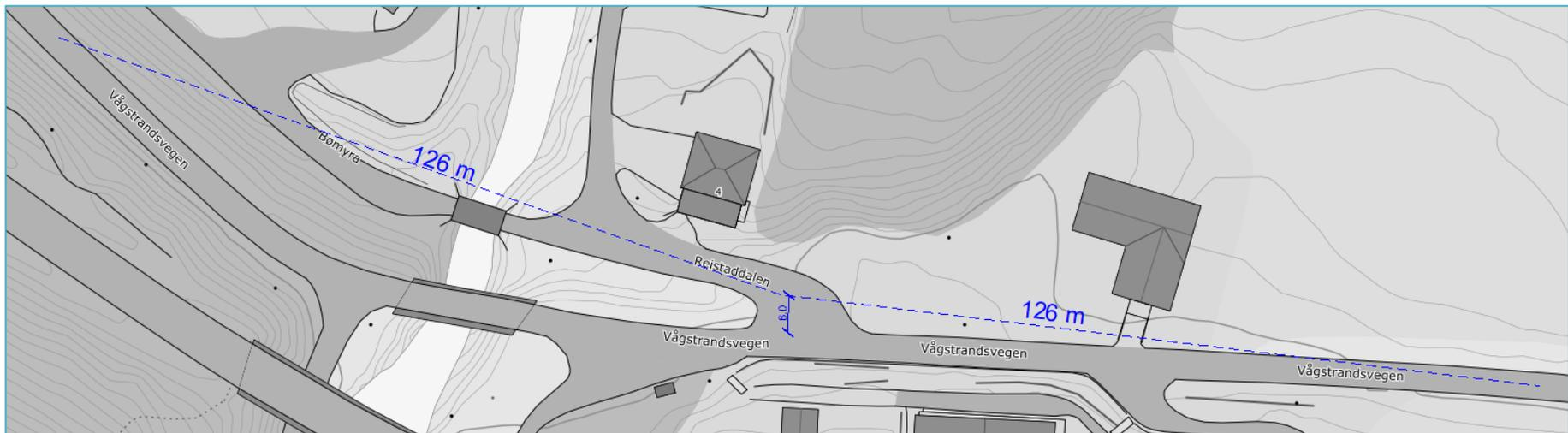
Figur. 34 Krav til frisikt for kryss for vegklasse vegklasse L1 med fartsgrense 60 km/t for primærveg.
