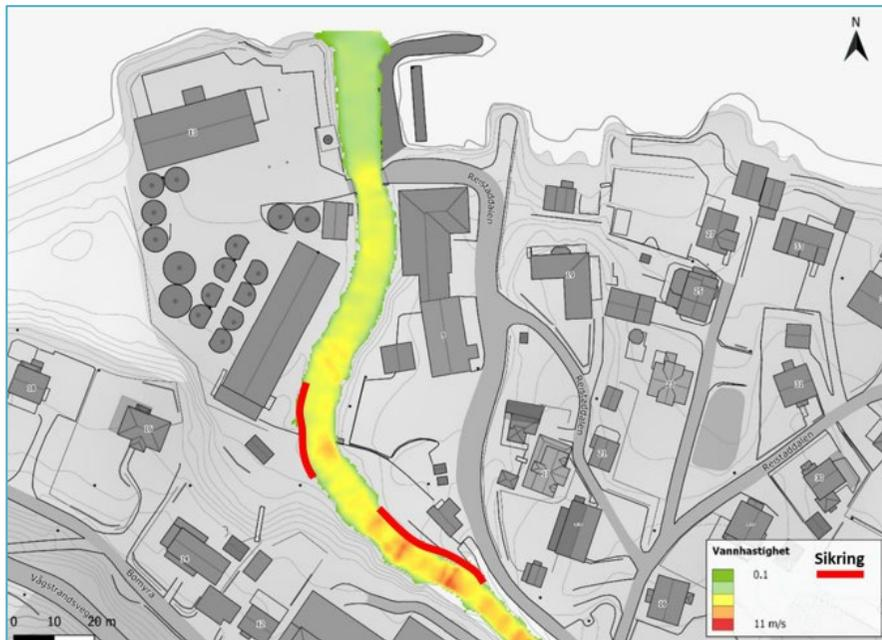
Figur. 38. Framlegg til sikring av planområdet mot flaum. og erosjon. Kjelde Hydrateam
