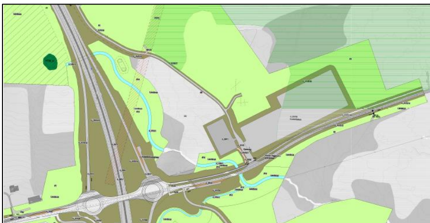
Figur 4. Veglinje med kontrollstasjon og parkering ved naturtypen intakt lavlandsmyr Øverås/Furland ved Elvestad markert med skravur.
