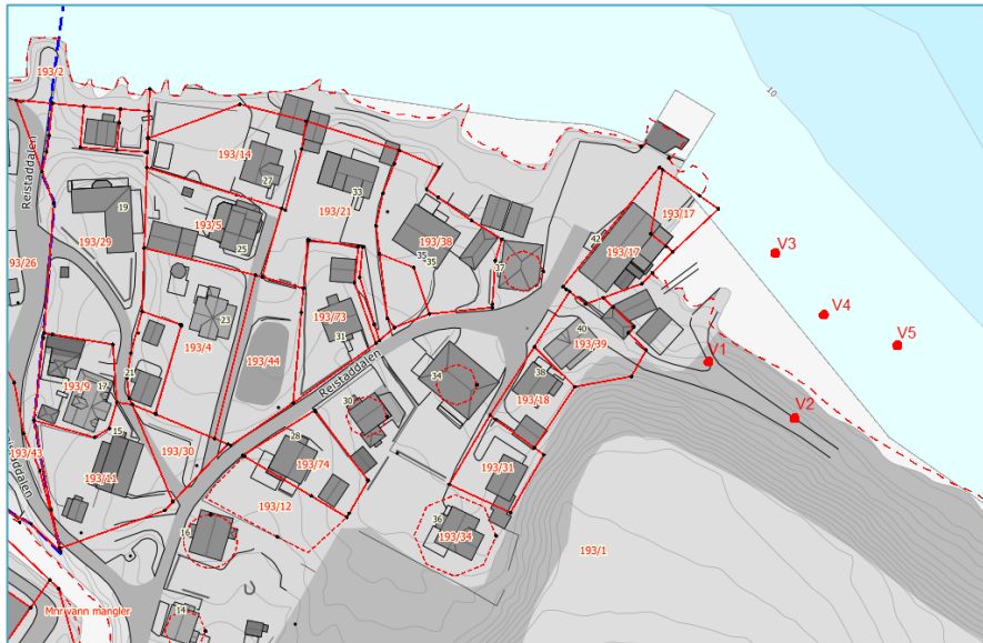
Figur. 36. Oversikt over borepunkt for grunnundersøking aust for planområdet, synt med raude punkt. Plangrensa kan skimtast i venstre del av utsnittet.
